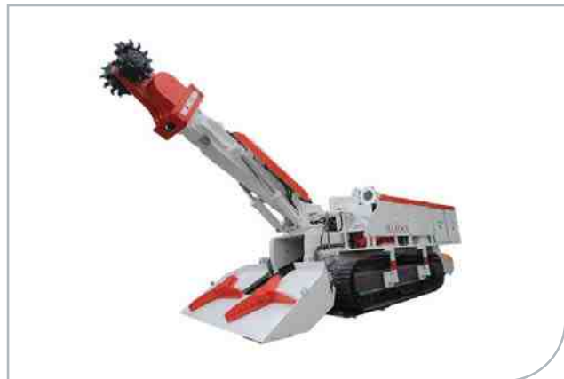
رود هدر برای حفاری تونل‌ها با اشکال و مقاطع مختلف (شرکت دانش بنیان شایان فناوران آمیتیس)
