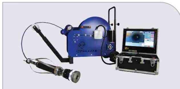
ربات بازرس تونل های شبکه انتقال و فوق توزیع (شرکت ایده کاوان صنعت پردیس)
